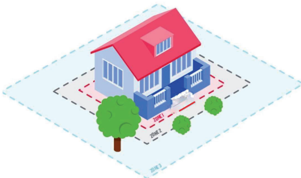
Σχήμα 4: Περιμετρική ζώνη προστασίας
